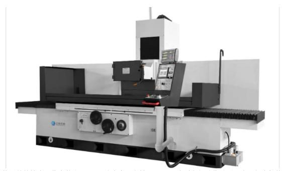
数控磨床使用前的检查工作有什么? 1、开动磨床,空转2□3min□查看各部动作是否正常。如有机构失灵,轴承过热,油压不够,砂轮摆动,工作台运动不平稳等不正常情况,应停车切断电源,采取措施处理,严禁使用者超越自检自修范围自行拆卸处理。2、检查冷却泵的电机运转是否正常,冷却液是否畅通。3、装卡砂轮时,砂轮和压板间应垫以0.5-1mm的纸垫,要用专门用的扳手,均匀用力紧固,不许用加长管子紧固,以免使砂轮胀裂。4、砂轮装好后应空载运转5min,操作者应避开正面,确认砂轮运转正常后,方准使用。浙江在线检测数控磨床批发价格数控磨床需要检查摇动手轮、工作台、砂轮架的往复运动是否良好。
